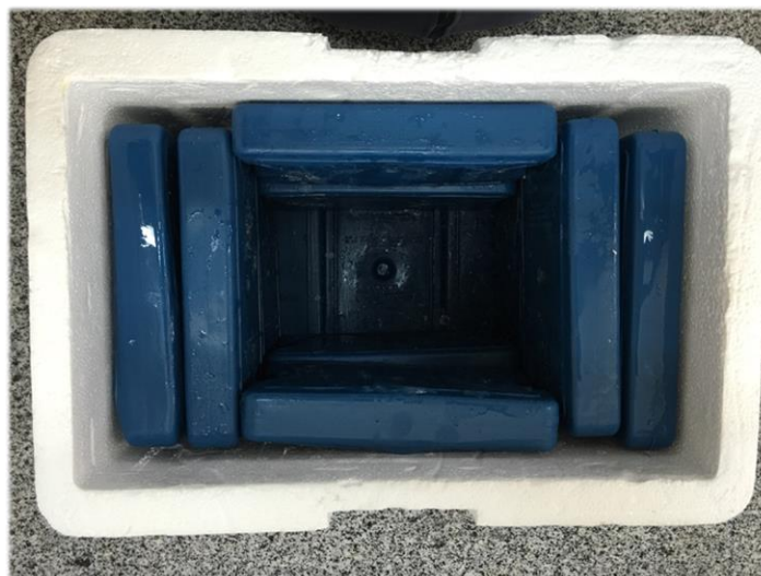
Figura 4 – Demonstração de como elaborar uma caixa para envio de amostras. Observar que para amostras de produtos resfriados e de pequeno volume, a quantidade de material refrigerante deve ser proporcional ao volume de amostra a ser preservado. Completar com plástico bolha os espaços da caixa.
