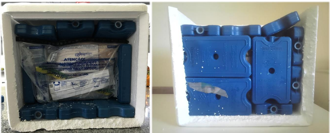
Figura 7 – Demonstração de um corte lateral da caixa após o acondicionamento das amostras.
