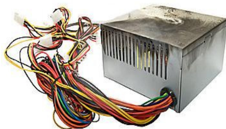
Figura 3 – Fonte de Alimentação queimada 11
