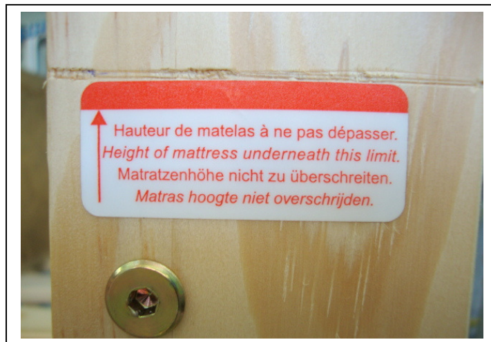
Foto 1- Exemplo de marcação na beliche realizada por fabricante para demonstrar ao consumidor a altura máxima que deve possuir o colchão (Foto tirada de beliche tipo exportação e exemplificativa de conformidade perante a norma DIN EN 747/2007 - Furniture - Bunk beds and high beds - Part 1: Safety, strength and durability requirements; Parts 2 : Safety Requirements and Test Methods).
